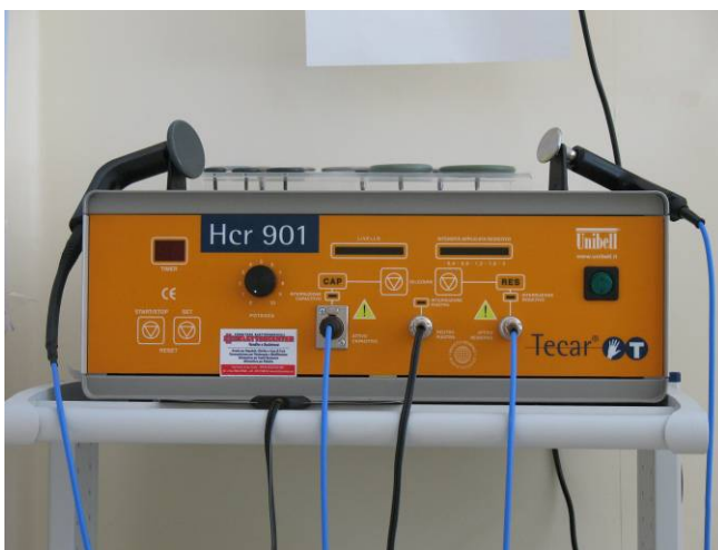
Figura 1. – Dispositivo di diatermia per il trasferimento energetico in modalità capacitiva e resistiva
