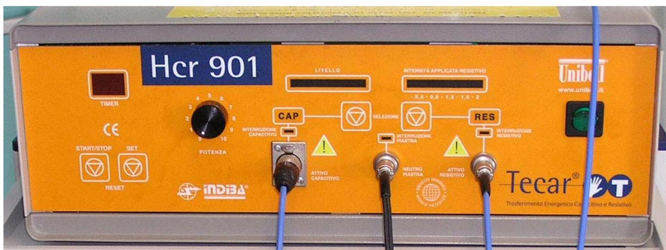
E' un'apparecchiatura a radiofrequenza che proietta energia utilizzando un segnale di frequenza relativamente basso 0,5 MHz ( 500.000 Hz) , ma che realizza il trasferimento di energia mediante il passaggio di corrente elettrica per effetto capacitivo e/o resistivo.
