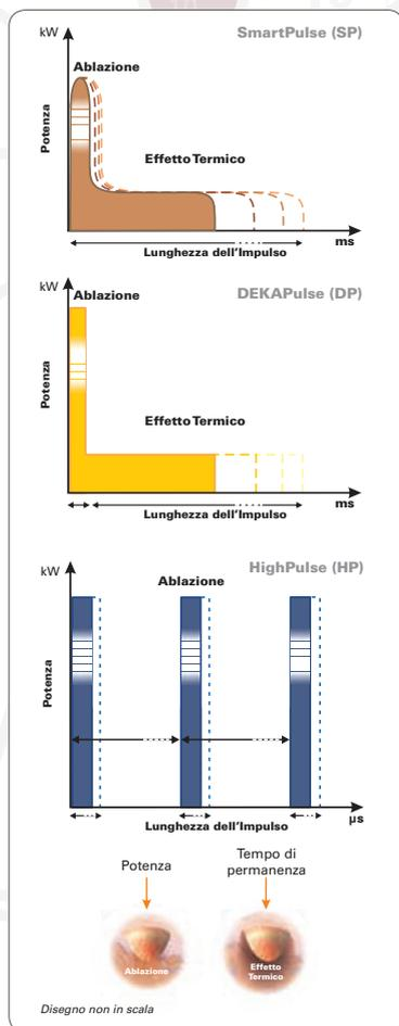
Con **SmartXide Touch**, la selezione degli impulsi consente una perfetta modulazione degli effetti di ablazione e denaturazione termica con la massima efficienza in base alle esigenze di ogni paziente.
